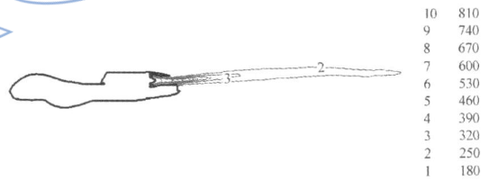
图 9 对称面上机身附近的温度分布(单位:K)
